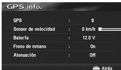
Parpadea cuando se recibe la señal del sensor de velocidad.
