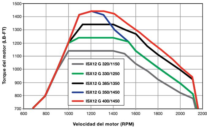
Con curvas de torque similares a las de los motores diésel ISX12, dentro del rango de 1559-1966 N•m (1150 libras-pie a 1450 libras-pie), el ISX12 G ofrece comparable rendimiento para vehículos y conducción superior.
