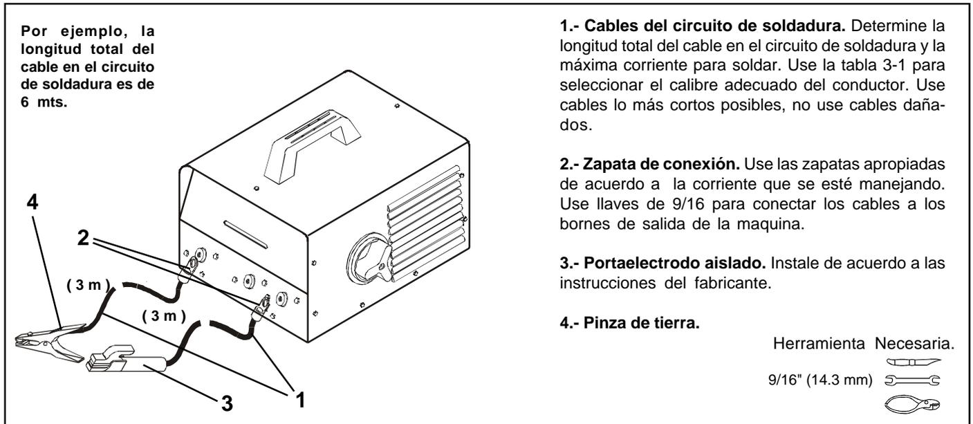
Figura 3-3 Selección de los Cables para Soldar
