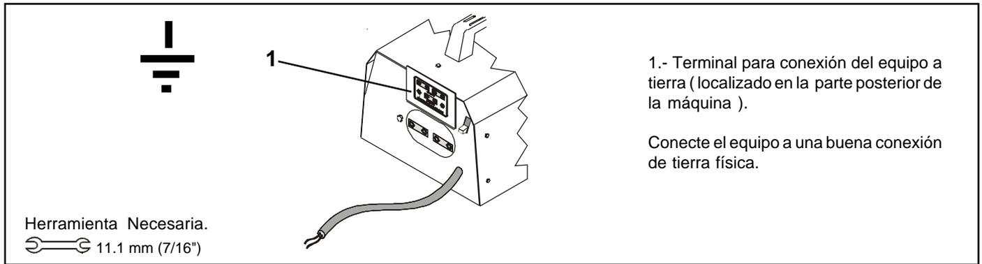
Figura 3-2 Conexión a Tierra de la Máquina Soldadora.
