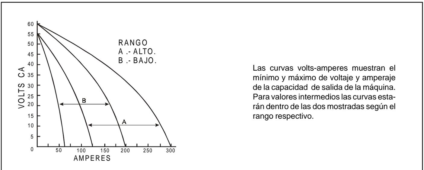
Figura 2-1 Curvas Volts-Amperes.
