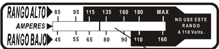
**1 ESCALA INDICADORA DE CORRIENTE.** Esta escala indica el amperaje de salida al que esta ajustada la máquina, para una mejor operación de soldadura.
