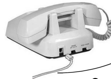
Conecte el cordón modular de línea telefónica del teléfono en el enchufe **TEL LINE [LÍNEA TELEFÓNICA]**.
