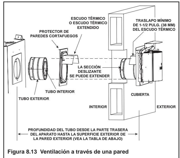
Figura 8.13 Ventilación a través de una pared
