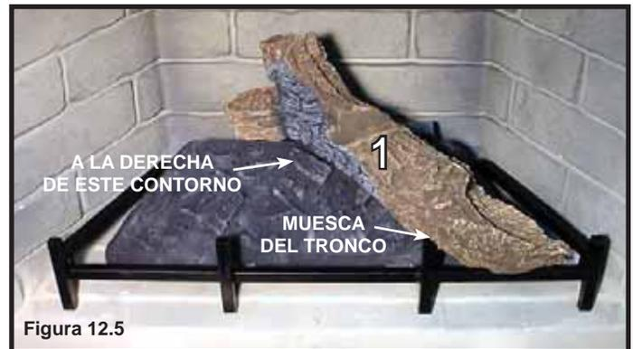
**PASO 3.** (SRV2081-170): Coloque el tronco N° 1 a lo largo del quemador para que el lado derecho del tronco descansa de manera plana sobre la barra frontal de la parrilla y el lado izquierdo se sobresalga de la parte de atrás del quemador. El contorno de la parte inferior del tronco se ajustará al contorno del quemador y la muesca del frente del quemador descansará sobre el segundo diente de derecha a izquierda.
