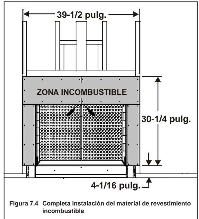
Figura 7.4 Completa instalación del material de revestimiento incombustible
