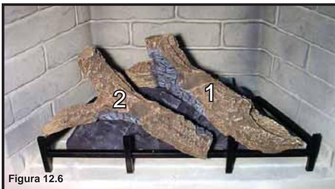
**PASO 4.** (SRV2081-171): Coloque el tronco N° 2 a lo largo del quemador para que las muescas de los extremos del tronco se encajen sobre la parrilla en ambos lados, la barra frontal y la de la izquierda. Los contornos de la parte inferior del tronco se ajustarán a los contornos de la superficie del quemador.
