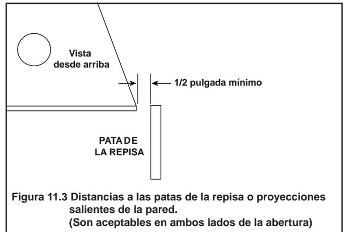
Figura 11.3 Distancias a las patas de la repisa o proyecciones salientes de la pared. (Son aceptables en ambos lados de la abertura)
