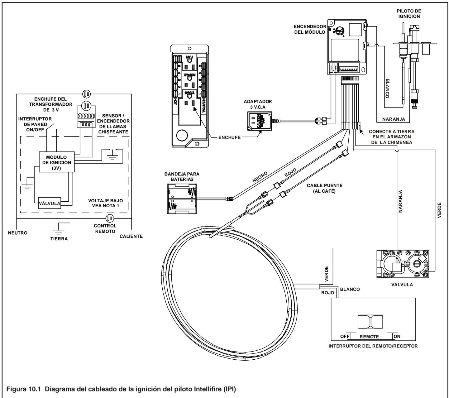
Figura 10.1 Diagrama del cableado de la ignición del piloto Intellifire (IPI)
