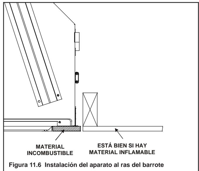
En cualquiera de estos casos, los materiales combustibles no deben traslapar la fachada del aparato y el material de acabado no debe sobrepasar el borde de metal de 3/8 de pulgada en torno a la abertura y no debe sobresalirse a la abertura del vidrio.
