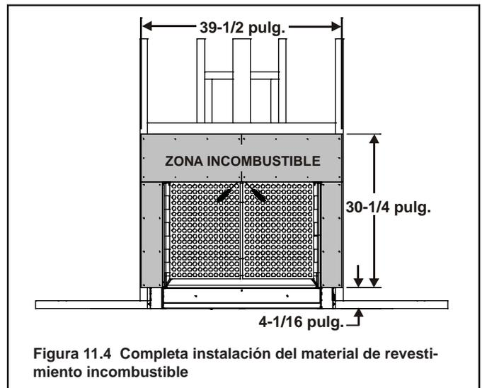
Figura 11.4 Completa instalación del material de revestimiento incombustible
