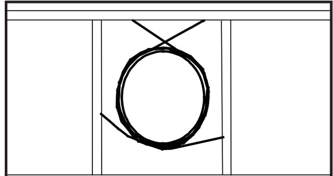
Figura 8.10 Sujeción de las secciones horizontales del tubo de escape
