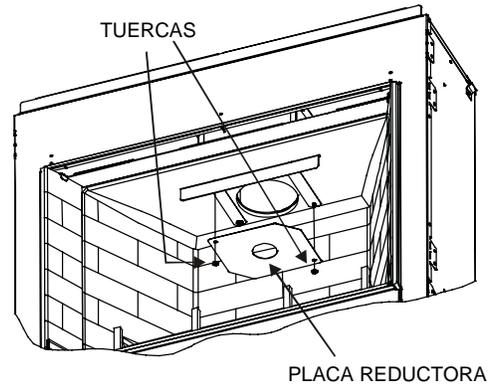
**NOTA:** Para una ventilación vertical de 8 pies o mayor, la placa reductora debe ser utilizada. La placa reductora del se envía en el lado derecho de la parte inferior del aparato. Para instalarla retire dos de las tuercas de 3/8 de pulgada de la parte de arriba de la cámara de combustión. Coloque la placa reductora sobre los pernos y vuelva a colocar las tuercas. Asegúrese de que las tuercas estén apretadas firmemente.
