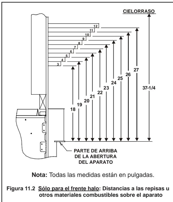
Figura 11.2 **Sólo para el frente halo:** Distancias a las repisas u otros materiales combustibles sobre el aparato
