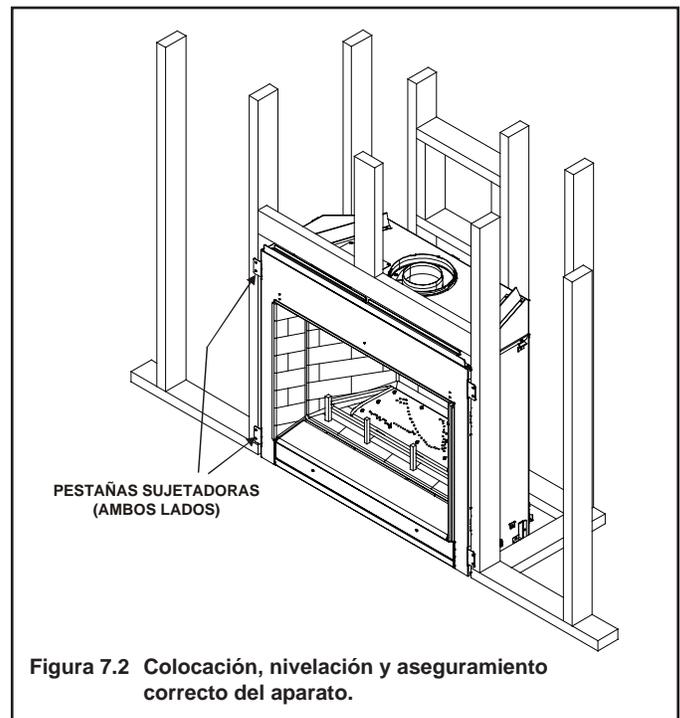
Figura 7.2 Colocación, nivelación y aseguramiento correcto del aparato.
