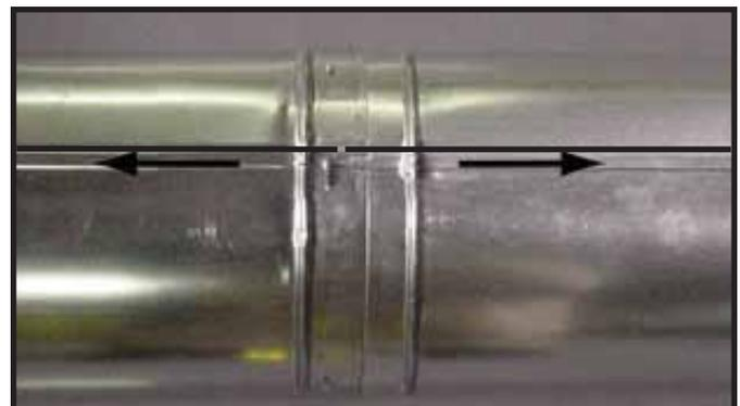
Figura 8.12 Alinee y separe las secciones del tubo de escape
