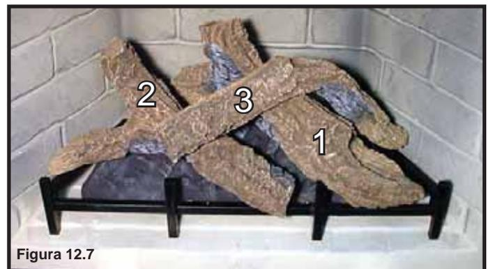
**PASO 5.** (SRV2081-172): El tronco N° 3 descansa sobre las partes lisas que están sobre ambos troncos, N° 1 y N° 2. El tronco N° 3 no tiene una muesca en uno de sus extremos que se vaya a encajar sobre la parrilla en el lado derecho.
