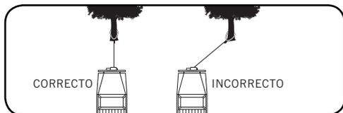
Las tracciones a corta distancia hechas en ángulo pueden ser usadas para reforzar el vehículo. Las tracciones a larga distancia deberán hacerse con el cable en un ángulo de 90° con respecto al malacate/ vehículo. Cuando arrastre una carga pesada, coloque una manta o una chaqueta sobre el cable a una distancia de cinco o seis pies (1,5 m-1,8 m) del gancho.
