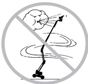
No utilice la máquina con viento fuerte o racheado. No aumente la superficie de la plataforma ni la carga. Si se aumenta la superficie expuesta al viento, se reducirá la estabilidad de la máquina.
