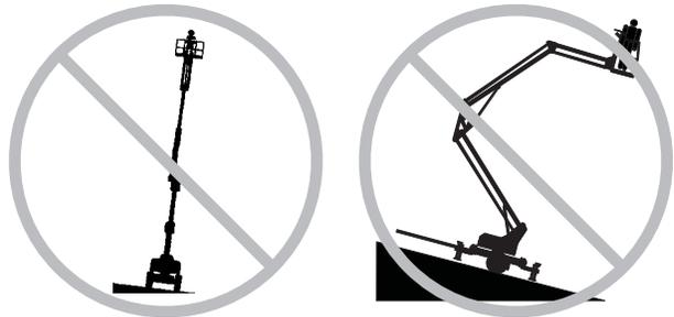
No eleve la pluma si los cuatro estabilizadores no están bajados, los soportes no están en contacto firme con el suelo o la máquina no está nivelada.
