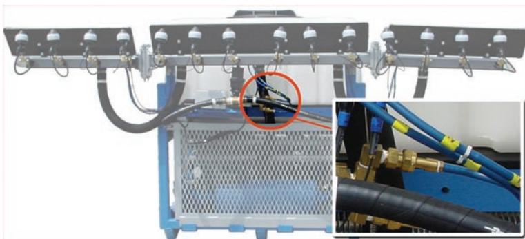
Tenga cuidado de no soltar los discos de flujo o de revolverlos cuando los ensamble (pueden ser diferentes entre las barras de aspersión). Con todas las válvulas de bola abiertas, opere la aspersora para purgar por completo todas las líneas.
