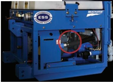
Mientras la unidad esté en funcionamiento, inspeccione el calibrador del reductor de vacío del lado de la entrada del soplador. Limpie o reemplace el filtro de aire si el calibrador está en rojo.
