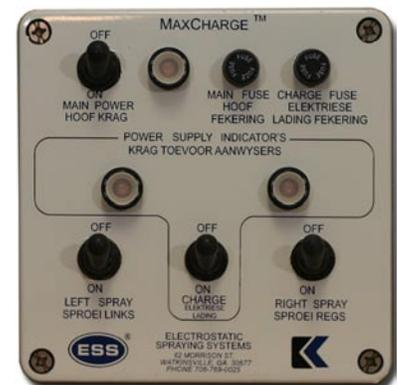
Fije el cable rojo directamente en el poste de la terminal de 12 voltios de la batería del tractor y el cable verde directamente en el poste de tierra del tractor. No poner a tierra el sistema en forma adecuada puede causar la falla prematura del suministro de energía. Asegúrese de no operar en un sistema de tractor de 24 voltios. Contacte al representante de servicio de ESS para obtener instrucciones en este caso.
