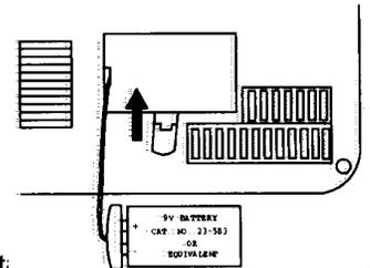
**Not:** - de batería no se apaga, oprima SNOOZE para reiniciar el indicador. Si este permanece encendido después de oprimir SNOOZE, reemplace la batería de respaldo.
