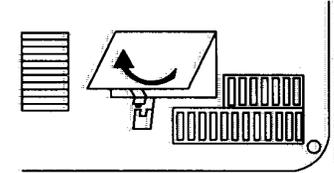
2. Conecte los contactores de batería del radio reloj en las terminales de las baterías dentro del compartimiento. El indicador SENTINEL de batería se apagará.
