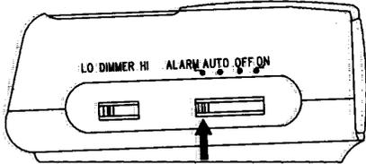
A la hora preajustada, la alarma sonará y se apagará dos horas después.
