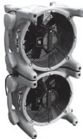
*Empilage des appareils* – placer l'Ace TurboDryer sur ses pieds larges (poignée sur le côté) puis sur une surface horizontale stable. Placer un deuxième Ace TurboDryer au-dessus du premier de sorte que ses pieds de caoutchouc se placent dans les évidements pratiqués sur l'appareil inférieur. Lors de l'empilage d'appareils pour une certaine application, on doit toujours prendre les précautions nécessaires pour éviter les accidents ou l'endommagement du matériel en cas de chute d'un appareil.
