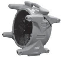
*Inclinación hacia atrás:* Coloque la Ace sobre las patas estrechas (con la manija en la parte superior). Incline la Ace hacia atrás hasta que la unidad descansa en las patas inferiores. En esta posición se crea un flujo angulado para secar objetos y materiales elevados.
