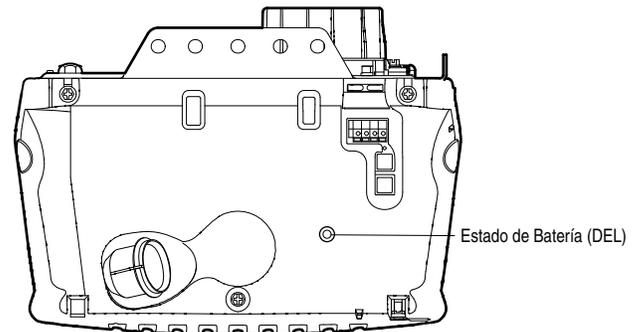
**NOTA:** El indicador DEL es mas visible con el luz apagado.
