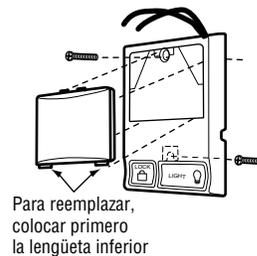
**Figura 2** INSTALACIÓN PRECABLEADA
