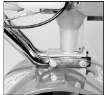
Ilustración 2 Nótese cómo el motor está apoyado totalmente sobre la transmisión helicoidal.
