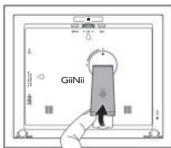
2. Para colocar el Picture Frame horizontal o verticalmente, se puede girar el pedestal trasero alineando la marca triangular con los puntos redondeados (1 o 2).
