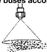
1. Buse à jet conique fixe : cette buse pulvérise une brume uniforme sur la cible. Conçue pour la pulvérisation de pesticides. Suivez le vent et déplacez-vous parallèlement au vent lors de la pulvérisation.
