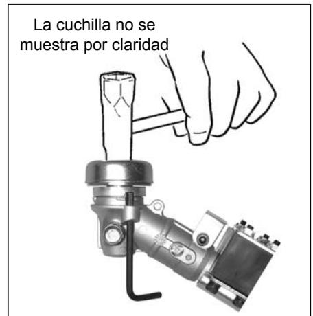
**La caja de engranajes con el lado de montaje del agujero de fijación de la herramienta y eje estriado:**
