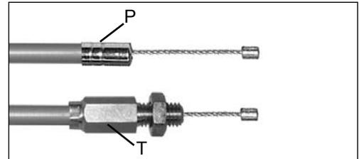
Unidades con dispositivo de ajuste del cable del acelerador (T) unido a extremo del cable (T):
