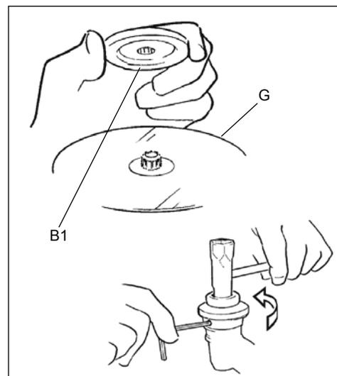
**La unidad debe estar ahora completamente ensamblada y lista para ser usada con una cuchilla.**
