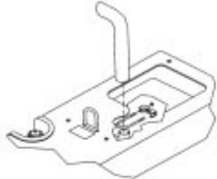
Localice el tubo de escape en la dirección deseada. Si la maquina esta instalada en una camioneta ó remolque, no localice el tubo en la dirección de circulación
