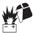
**LAS CHISPAS** pueden causar que los gases producidos por las baterías **EXPLOTEN**; los ácidos de las baterías pueden causar quemaduras en los ojos y piel.
