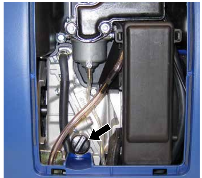
Figura 17 – Tapón de llenado/drenaje de aceite
