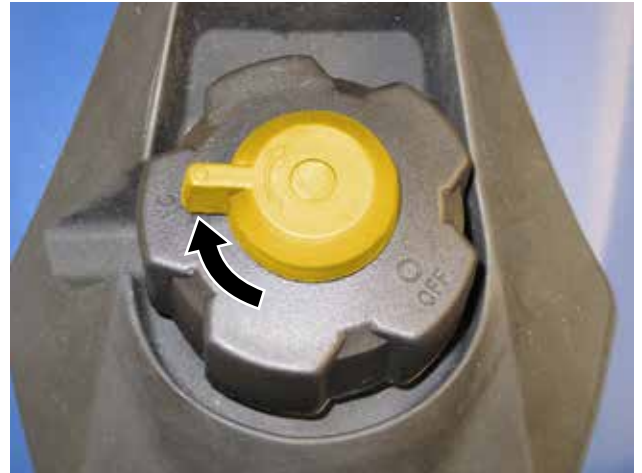
Figura 27 – Ventilación del depósito de combustible
