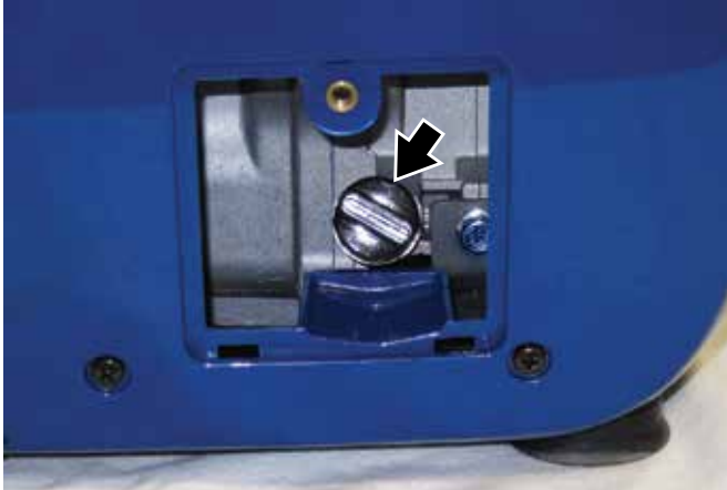
Figura 22 – Tapón de llenado/drenaje de aceite
