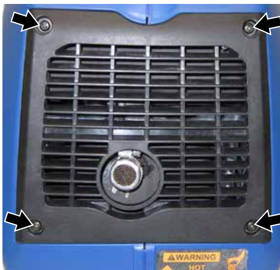
Figura 52 – Cubierta del silenciador
