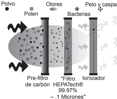
La ilustración de arriba indica la forma en que funciona el sistema de purificación de aire HEPATech™. El polvo y otros irritantes son aspirados por el sistema de purificación de aire y limpiados a través del pre-filtro de carbón, el filtro HEPATech™ y por el ionizador. Entonces, aire limpio y purificado es liberado dentro de la habitación a través de la rejilla superior.
