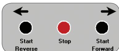
• Arranque marcha atrás - Ajusta el equipo para que funcione en la dirección hacia atrás.
