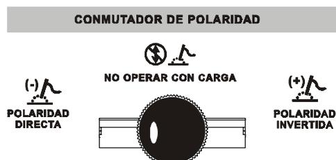
FIGURA 4-4 CONMUTADOR DE POLARIDAD.
