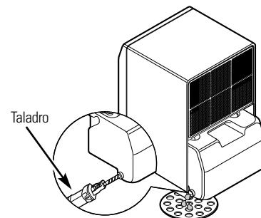
**NOTA:** Una boquilla perforada no podrá repararse después de la perforación. Use un tapón con rosca de manguera de jardín si es necesario taparlo (no incluido).
