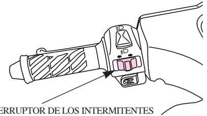
Cuando se acciona este interruptor con el contacto en posición ON, se pone en marcha el intermitente.
