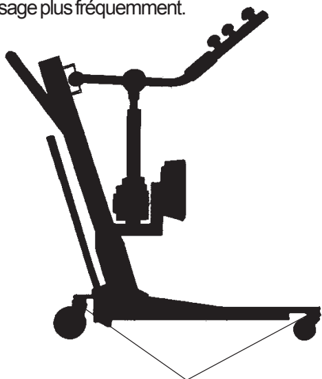
Graissez les roulements et les pivots des roulettes SCHEMA 1 - GRAISSAGE
