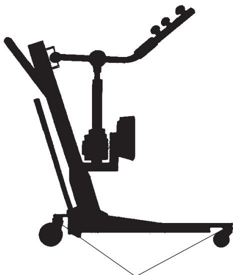
Schmieren Sie die Lager der schwenkbaren Räder
