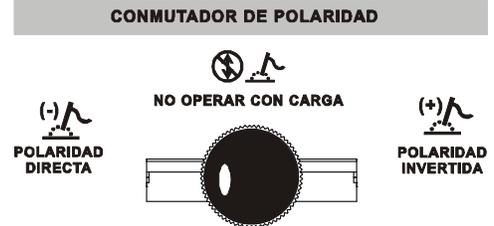
FIGURA 4-4 CONMUTADOR DE POLARIDAD.
