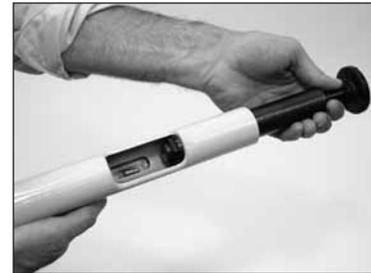
5. Después de efectuar la fijación, levante la herramienta de la superficie de trabajo y tire de la pieza delantera con fuerza hacia adelante, o abra la herramienta girando la muñeca. Esta acción volverá a colocar el pistón en su posición y eyectará el cuerpo de la carga de pólvora de la recámara.
