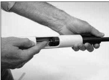
3. Seleccione la carga de engarce "A", calibre .22 apropiada e introdúzcala en la recámara de disparo. Nota: se debe deslizar el tambor hacia atrás aproximadamente 1/2" para permitir que la carga se asiente completamente a nivel en la recámara. Con la carga de pólvora totalmente asentada, deslice cuidadosamente el tambor para cerrarlo.
