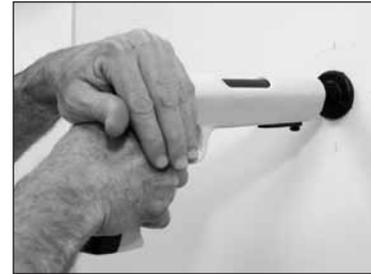
4. Presione la herramienta con firmeza contra la superficie de trabajo con ambas manos y luego jale el gatillo. Asegúrese de mantener la herramienta perpendicular a la superficie. Si utiliza el supresor de fragmentos de caucho que se incluye en el juego de la herramienta, se asegurará de que la herramienta esté perpendicular a la superficie de trabajo y, además, se reducirá la cantidad de fragmentos de concreto que se desprendan cuando instale el sujetador.
