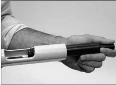
1. Abra la herramienta. Tome la pieza delantera y tire con fuerza hacia adelante hasta sentir un golpe, luego tire la pieza delantera hacia atrás hasta que se detenga y esté totalmente cerrada. Esto vuelve a colocar el pistón en posición.
