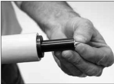
2. Introduzca el sujetador en la pieza delantera de la herramienta, con el extremo roscado o la cabeza primero. Empuje el sujetador hasta que el extremo con punta esté al mismo nivel que la cara de la pieza delantera o, si se utiliza un sujetador prearmado, hasta que la pieza delantera esté contra el accesorio del sujetador.
