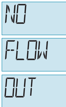
Imagen 3-5: Alarma NO FLOW OUT (Sin flujo de salida)
