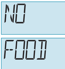
Imagen 3-6: Alarma NO FOOD (Sin alimentación)
