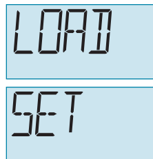
Imagen 3-2: Alarma LOAD SET (Cargar juego)
