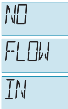
Imagen 3-4: Alarma NO FLOW IN (Sin flujo de entrada)
