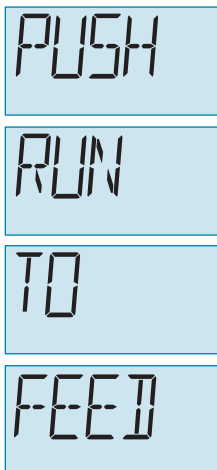
Imagen 3-7: Alarma PUSH RUN TO FEED (Presionar RUN para alimentar)
