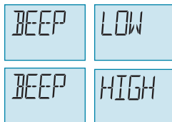
Imagen 2-27: Configuraciones del volumen de la alarma; BEEP LOW (Sonido bajo) y BEEP HIGH (Sonido alto)
