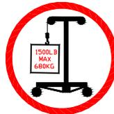
Verifique el balance de la carga antes de levantarla. No exceda la capacidad nominal de la carga. Nunca use dos elevadores para levantar una carga que exceda la capacidad de un elevador sencillo.
