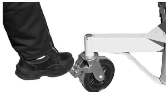
1. Ponga el freno presionando hacia abajo la palanca del freno como se muestra.
