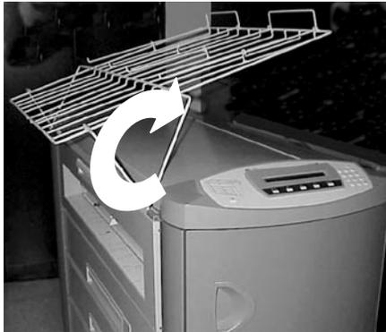
1. Levante la bandeja de salida de manera tal que se apoye en la parte superior de la impresora.
