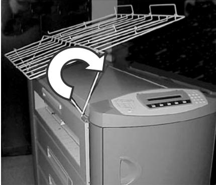
2. Levante la manija del módulo correspondiente y abra el módulo completamente.
