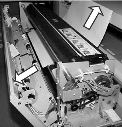
5. Mantenga la parte delantera del módulo completamente abierta y retire el papel atascado de la parte posterior del área del fusor.
