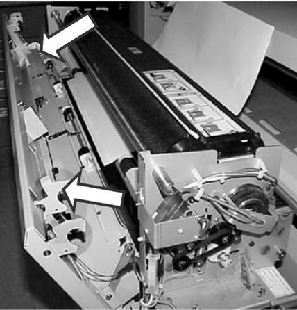
4. Levante los enganches internos a cada lado del módulo del fusor y baje la parte delantera del módulo del fusor.
