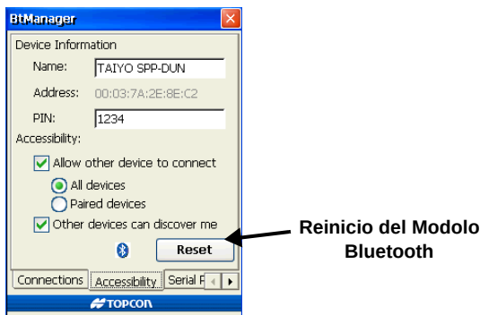
Figura A-6. Reinicio del Módulo Bluetooth
