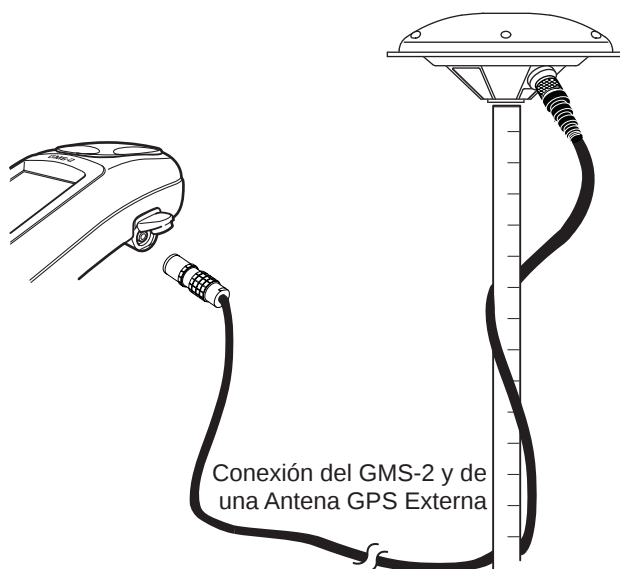
Figure 3-8. Instalación del GMS-2 y de la Antena PG-A5
