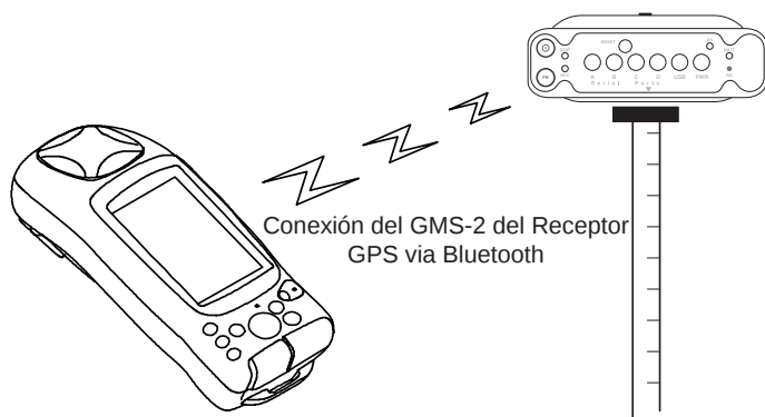
Figure 3-10. Instalación del GMS-2 y de un Receptor de la Serie Hiper (Con Bluetooth)
