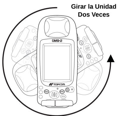
Figura A-11. Calibración de la Brújula
