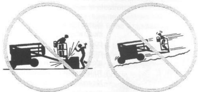
Controle la velocidad de desplazamiento de acuerdo a las condiciones de la superficie, tráfico, pendiente, posición del peruánal y cualquier otro posible factor que pudiera causar una colisión.
