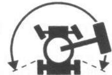
23 Haga girar la tornamesa a su posición de almacenaje con el brazo primario colocado entre las ruedas fijas.
