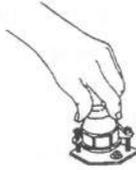
11 Presione el sensor de inclinación hacia un lado.
