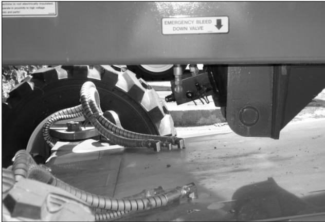
Figura 5 – La bajada de emergencia de la válvula
