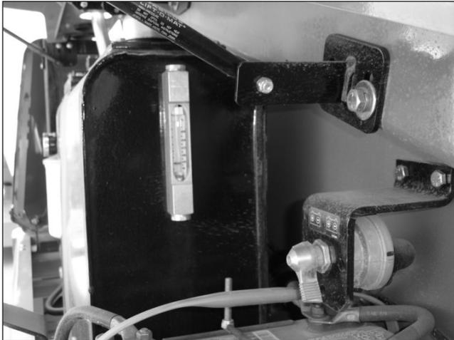
Figura 8 – Depósito de fluido hidráulico
