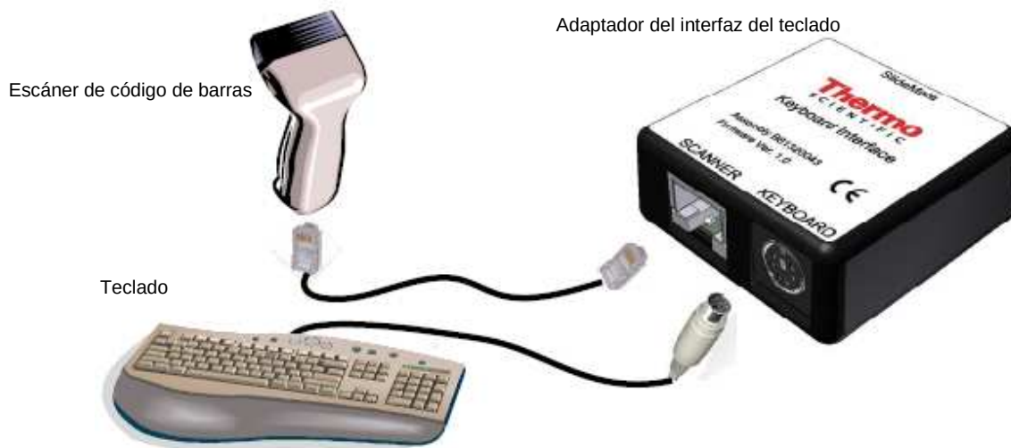
Figura 20 - Conexión del teclado y del escáner de código de barras
