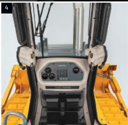
1. La palanca con diseño ergonómico proporciona control intuitivo de la dirección, desplazamiento hacia adelante y en reversa y velocidad sobre el suelo. Posee un retén, de manera que no requiere de atención constante. Además, emplea un interruptor de velocidad de desplazamiento que se acciona con el dedo.
