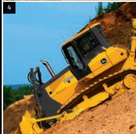
1. El control de las orugas infinitamente variable permite que el operador aumente o disminuya la potencia de cada oruga para poder realizar giros completos en potencia máxima.
