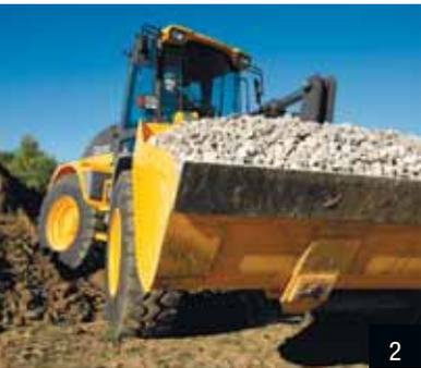
2. El eje trasero oscilante y la articulación del bastidor delantero proporcionan un transporte suave sobre terreno accidentado — para ciclos más rápidos y una mejor retención del material.
