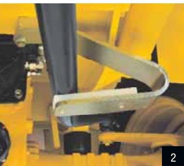
2. El varillaje de la dirección se ubica en un lugar protegido y apoyado por soportes con tiras de desgaste fácilmente reemplazables.
