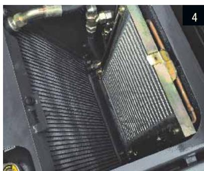
4. El condensador del acondicionador de aire se inclina y aleja fácilmente del radiador para facilitar la limpieza. No es necesario vaciar los fluidos ni desconectar mangueras.
