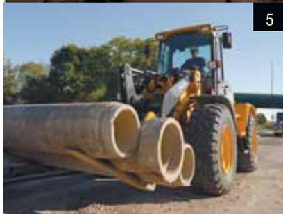
5. El acoplador rápido hidráulico opcional facilita la realización de trabajos múltiples, cambiando de cucharón a horquillas en sólo segundos sin tener que levantarse del asiento.
