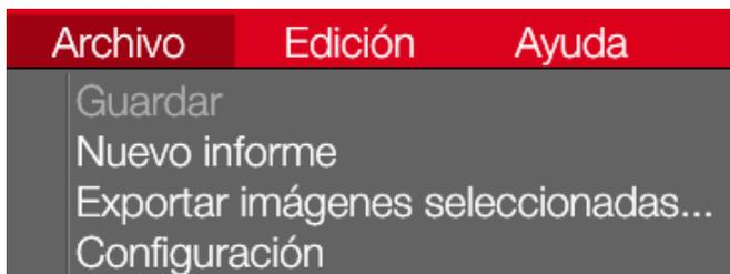
El menú Archivo es una manera de iniciar un nuevo informe, de exportar imágenes que cargó desde la cámara termográfica a una carpeta de la computadora o de cambiar la configuración del Software. Vea a continuación:
