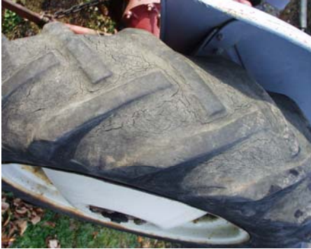
Fig. 4.6.5.b. Las orugas desgastadas y podridas por hongos hacen una mala tracción y ponen el riesgo de que se revienten cuando se pasen de tiempo.
