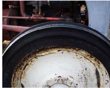
Fig. 4.6.5.c. Los aros dañados por el uso descuidado pueden causarle daños a las llantas como tetos o alisamientos
