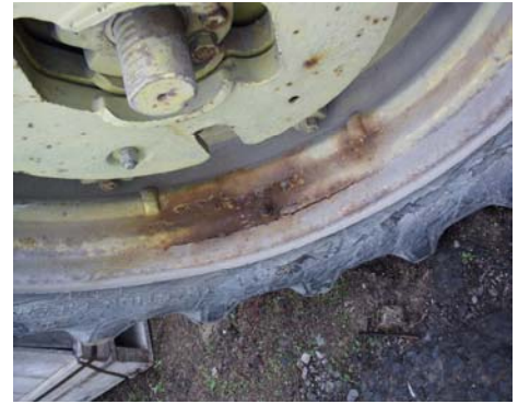
Fig. 4.6.5.d. Una válvula de aire que gotea, libera la solución de calcio herrumbando el aro. Un gasto mayor puede ocurrir, así como aumentar el grado de peligro en la seguridad usando éste tractor
