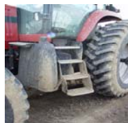
Figura 4.6.6.b. Se cuentan muchas caídas entre las lesiones en las fincas. Mantenga las gradas de la plataforma limpias de lodo, estiércol y herramientas
