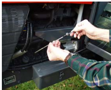
Fig. 4.6.1.c. Revisar el nivel de aceite.
