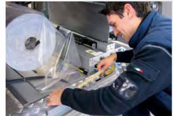
Aumenta además la precisión de los enlaces de las bobinas de film impreso o neutro con muesca, con posicionamiento de  $\pm 10$  mm desde la referencia de la muesca.
