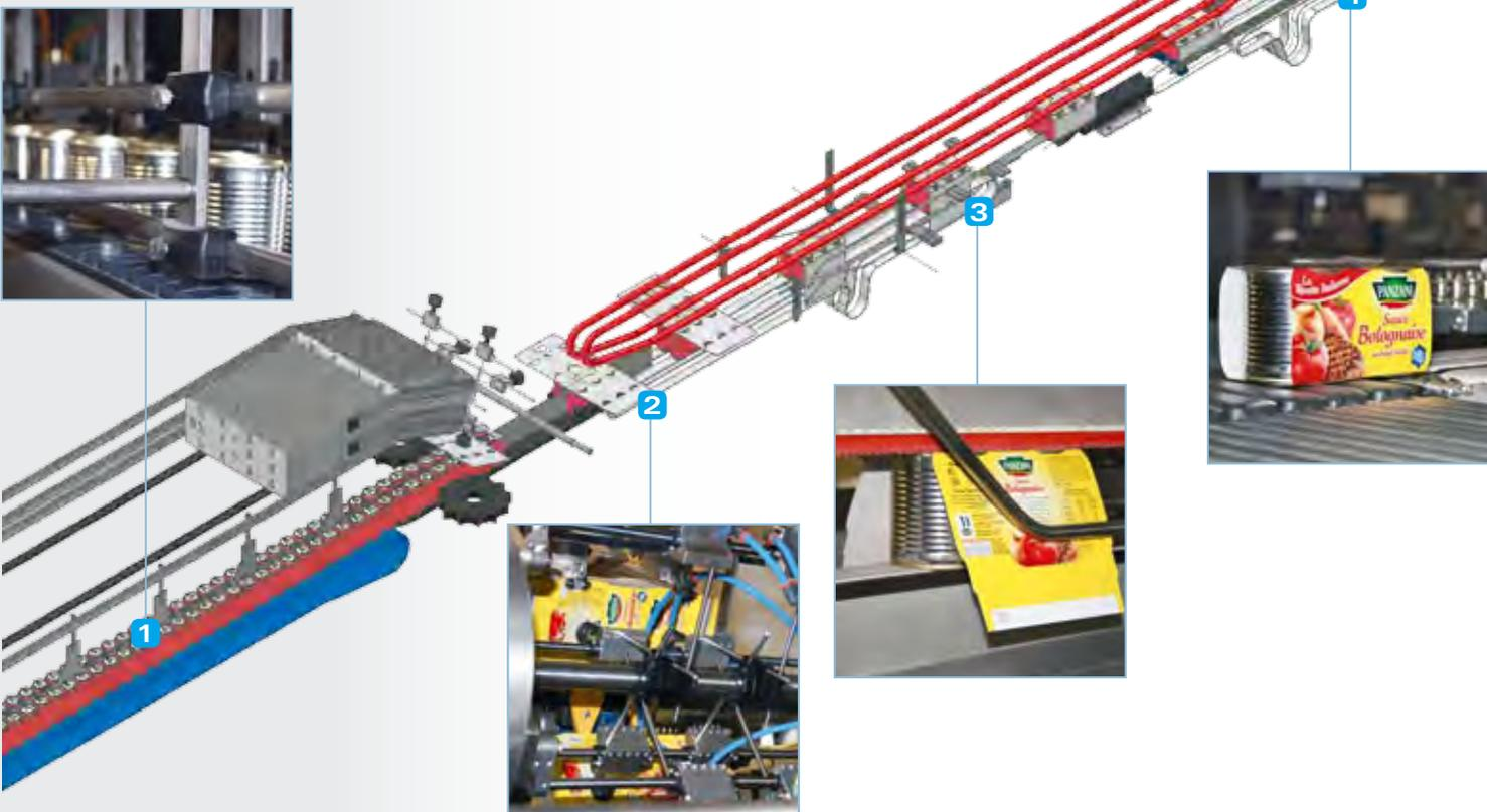
**1** En la zona de entrada de la máquina, un grupo especial de guías canaliza correctamente los envases sueltos, conducidos por medio de una cinta transportadora con cadenas en material termoplástico de bajo coeficiente de fricción.
