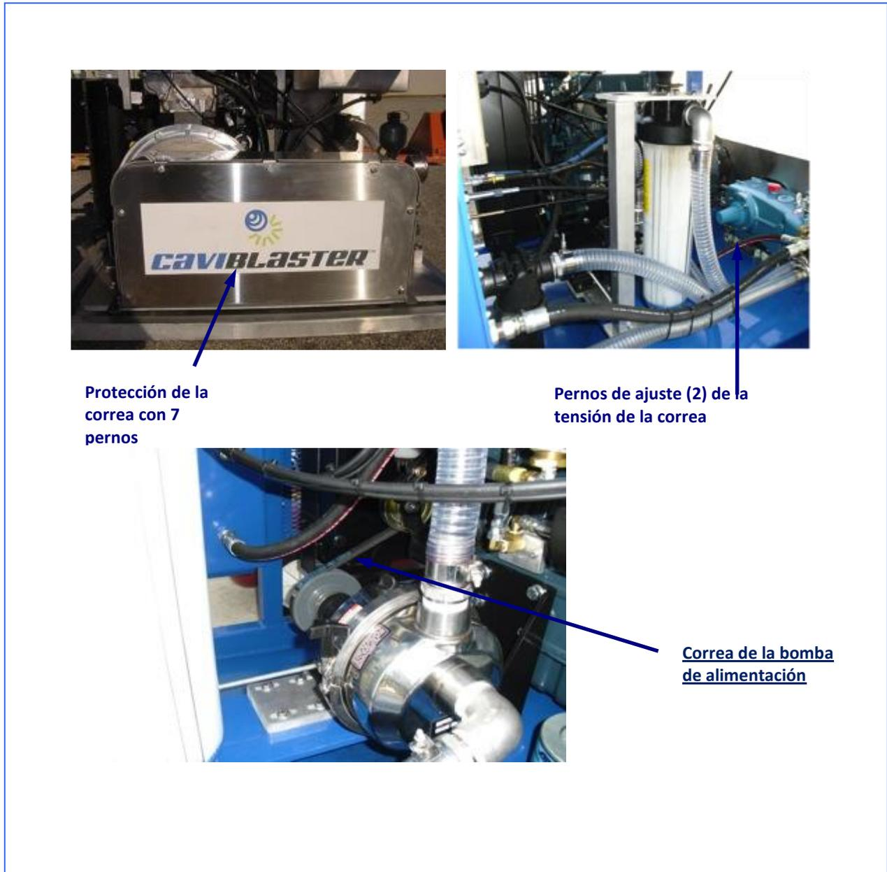
Figure 6.2 – Inspección / Tensión de la correa.
