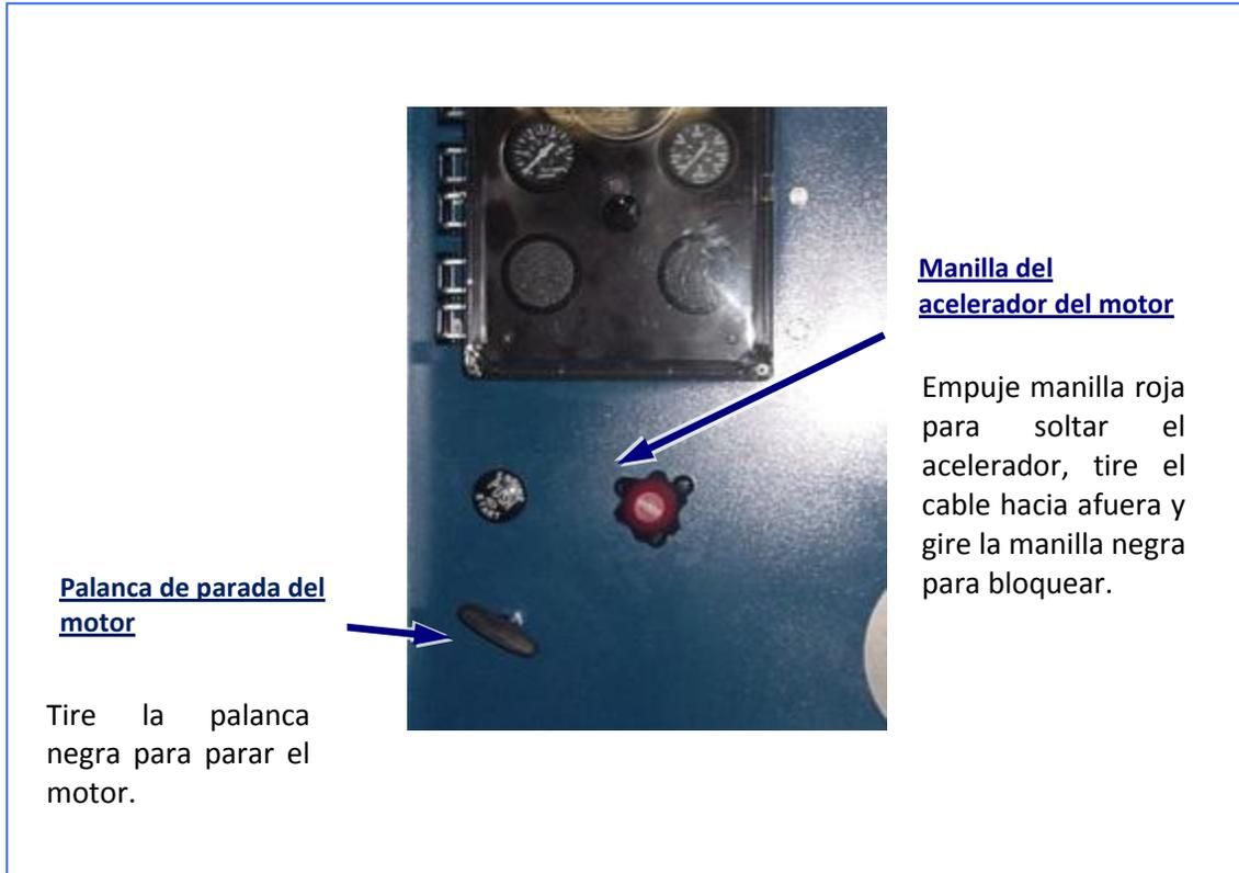
Figura 5.1 – Detención del motor y control del acelerador.
