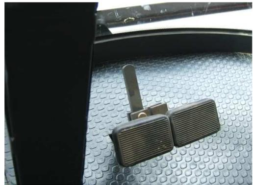
**Figura 11. Pedales de freno acoplados y pedales con freno individual**
