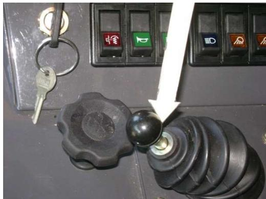
**Figura 12. Acelerador del motor**
