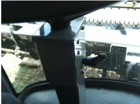
**Figura 19. Ajuste anatómico del volante de dirección**
