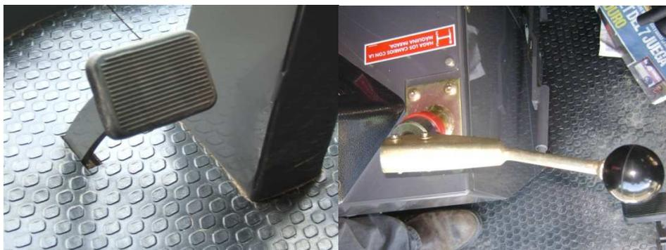
**Figura 9. Pedal de embrague y palanca de cambios de marcha**
