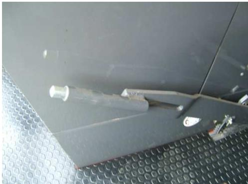
**Figura 22. Palanca de regulación de holgura del cóncavo**
