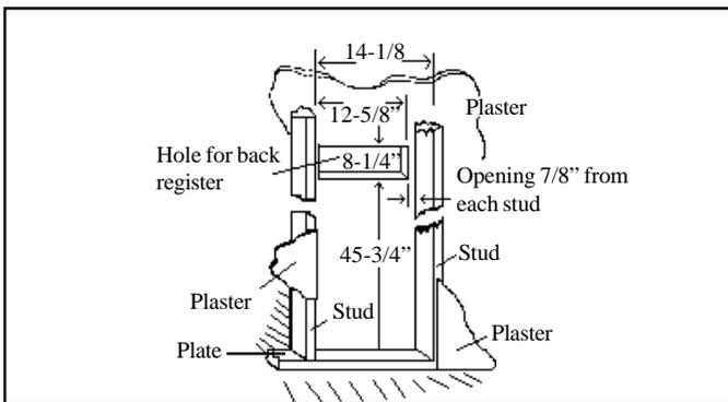
FIG. 6 - ROUGH-IN DIMENSION FOR REAR REGISTER
