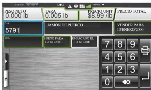
Para cambiar los valores del campo: Seleccione el campo y realice el cambio con el teclado numérico; después presione Enter. Se mostrará el valor que se cambió en el campo correspondiente. Esto aplica para el precio unitario, el número de producto, por pieza, bueno para (horas), la vida del producto (horas), las claves de etiquetas primarias y adicionales en la pantalla central del operador.
