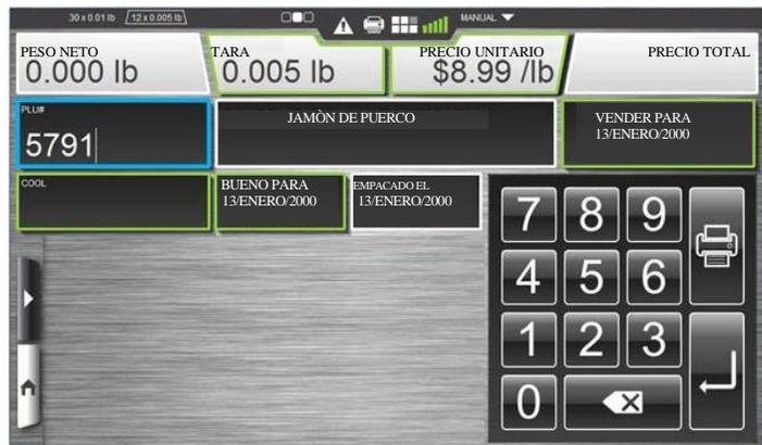
Para pesar en el modo manual normal: Coloque el producto en la báscula y toque el ícono de imprimir
