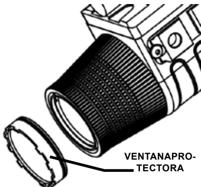
Figura 2-5 Instalación de la Ventana Protectora
