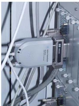
**Figura 6** Conexión de la interfase USB-GPIB
