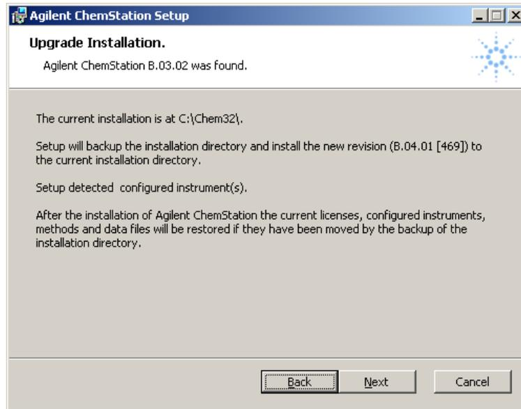
El asistente para la instalación de ChemStation informa qué revisión de la ChemStation ha detectado y la ubicación de la instalación actual. Puede comenzar la actualización de esta ChemStation pulsando **Next**.
