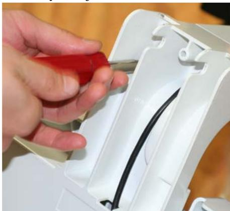
*Figura 3-4. Fijación de la Columna a la Base por Medio de los Tornillos.*
