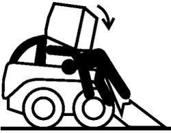
Leer y comprender el Manual del operador antes de elevar la ROPS. El no hacerlo puede causar la caída de la cabina y causar lesiones graves.
