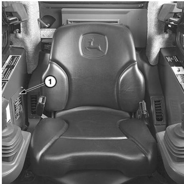
Cubierta de tablero de fusibles
