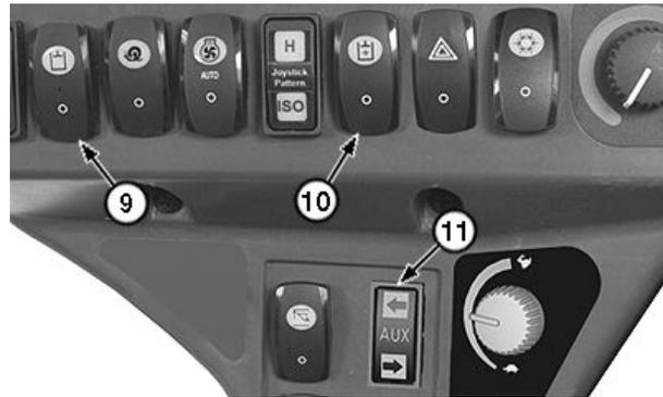
Interruptores de anulación auxiliar, caudal alto y cuarta función auxiliar
