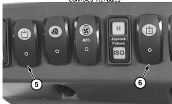
Interruptores de anulación y caudal alto del sistema hidráulico auxiliar
