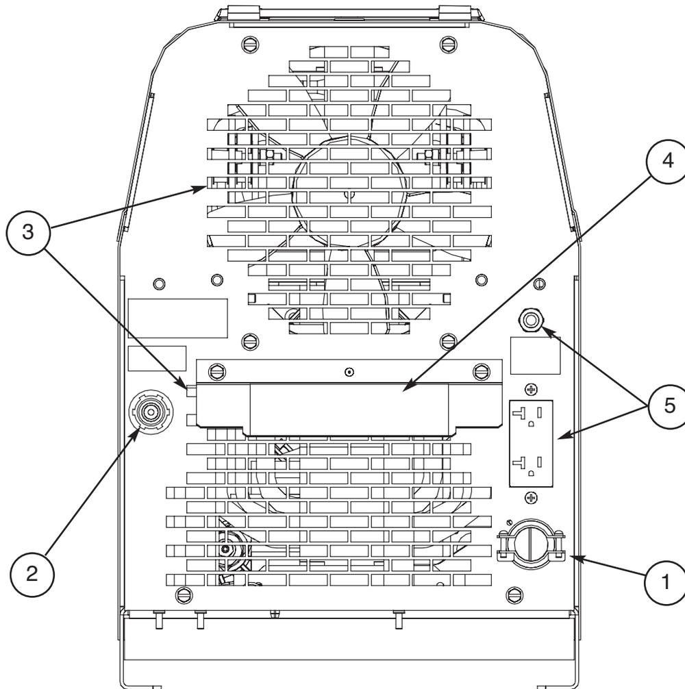
1. **CABLE DE ENTRADA** – Este cable de trabajo pesado #6-3 (208/230V) o #12-3 (380V y mayor) con pinza para cable viene instalado de fábrica en todos los modelos. Los modelos Nacionales (208/230V) también vienen equipados con un conector NEMA 6-50P.
