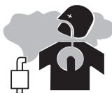
1.b. Los motores deben funcionar en lugares abiertos bien ventilados, o expulsar los gases de escape del motor al exterior.
