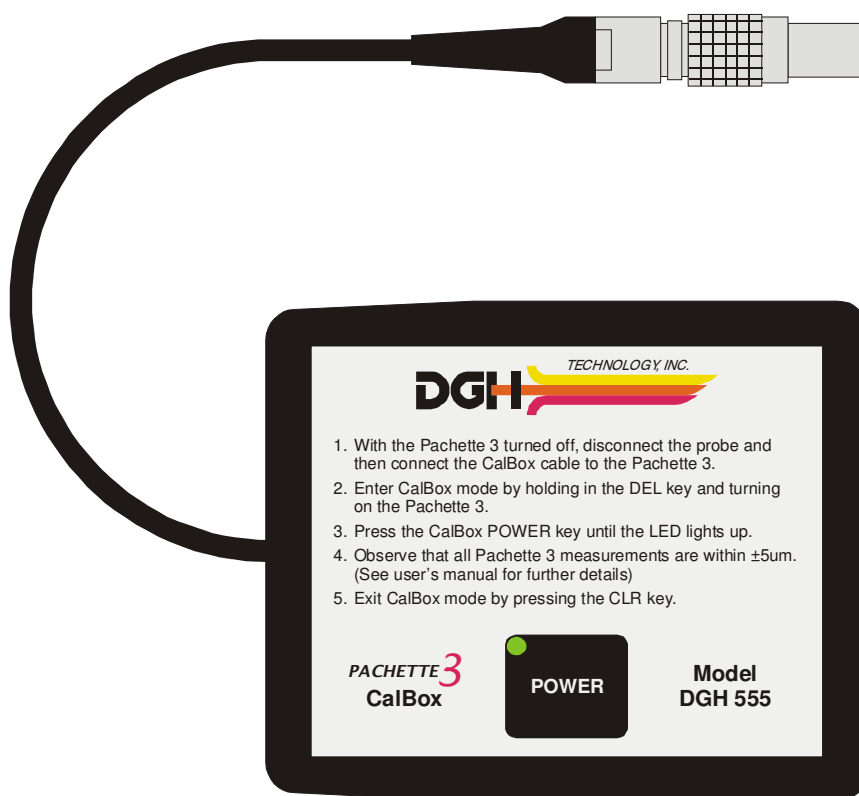
Figura III-E Dispositivo de calibración (CalBox) electrónico de DGH 555 Pachette 3
