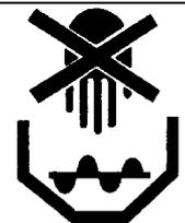
No abra ni quite las protecciones de seguridad con el motor en funcionamiento
