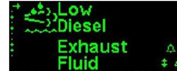
La pantalla de advertencia de DEF se muestra cuando el nivel del líquido DEF ha alcanzado un nivel críticamente bajo. Se puede eliminar al presionar intro en el MCS (Interrupción de control del menú). Esta advertencia puede estar acompañada por el nivel DEF en el rango bajo, la luz DEF fija o intermitente, la luz de Revisar motor, la luz de Detener el motor, la luz MIL o disminución del motor.
