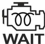
En condiciones frías, la luz Wait-to-Start (Esperar para arrancar) se iluminará al colocar la llave en on (encendido) y permanecerá encendida por un período de hasta 30 segundos.
