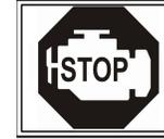
La luz STOP ENGINE (Detener el motor), cuando se enciende, indica la necesidad de detener el motor tan pronto como se pueda hacer de manera segura. **El motor debe permanecer apagado hasta que se pueda reparar.**
