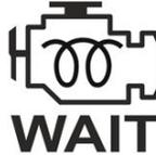
La luz WAIT TO START (esperar para arrancar) se enciende cuando el calefactor de aire de admisión (calefactor de rejilla) necesita calentar el aire de admisión antes de arrancar el motor.
